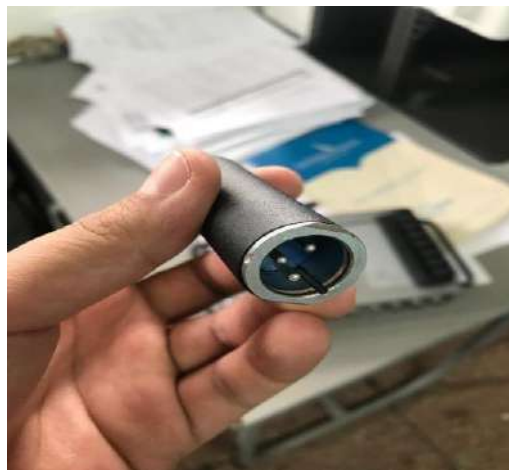
Gráfica N° 1. Transductor De Presión Utilizado Junto Al Osciloscopio Para Medir El Vacío Del Motor.
