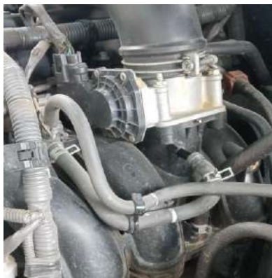
Gráfica N° 2. Toma De Vacío Para Realizar Mediciones.
