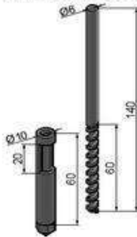
Gráfica N° 5. Diseño aproximado del tornillo extrusor experimental.
