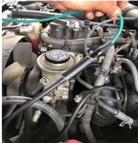
Gráfica N° 3. Conexión Del Transductor De Vacío A La Manguera De Admisión Y Al Osciloscopio.
