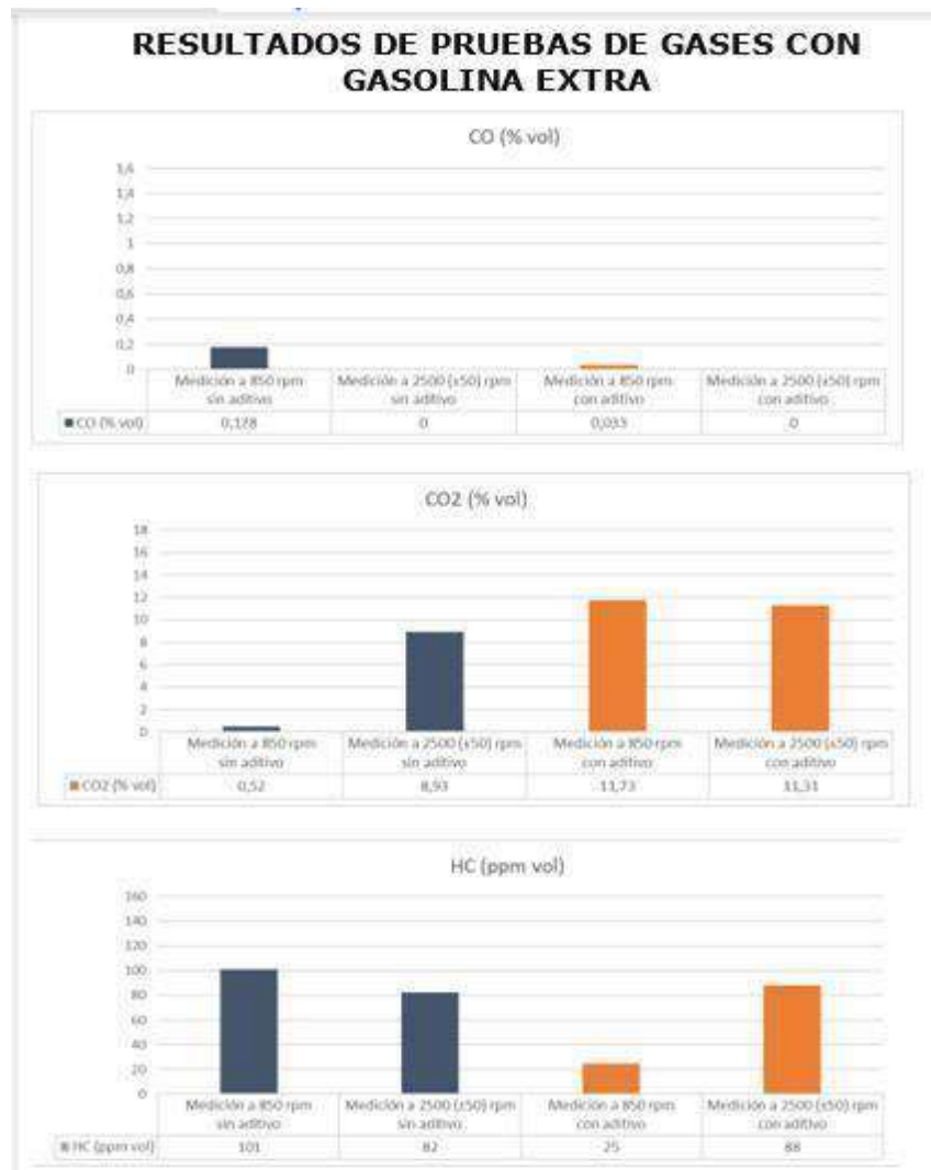
Gráfica N° 5. Resultados de pruebas de gases Gasolina Extra.
